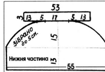
Мал. 14. Викрійка чепця Лідії Бричник. Нижню частину чепця потрібно зібрати на шнурок довжиною 40 см.
